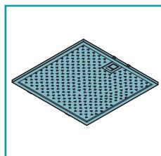
Metallfettfiltrene hvis funksjon er å samle fettpartikler: disse avsettes på filtrene og forsyner eventuelle flammer som sendes ut under koking, de genererer ubehagelig lukt og svekker luftpassasjen ved å redusere sugekapasiteten til ventilatorhetten.
