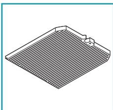
Los filtros de carbón activo tienen la función de retener los olores presentes en el flujo de aire que los atraviesa: el aire depurado mediante los pasos a través de los filtros se vuelve a introducir en el ambiente de la cocina.
