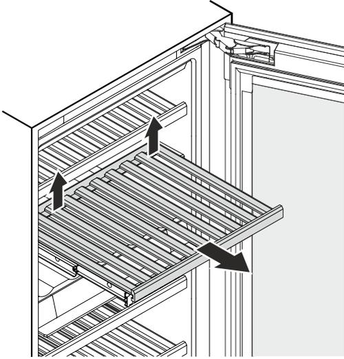
Soulever (déclipser) la partie arrière de la clayette en bois à droite et à gauche et la retirer vers l'avant.
