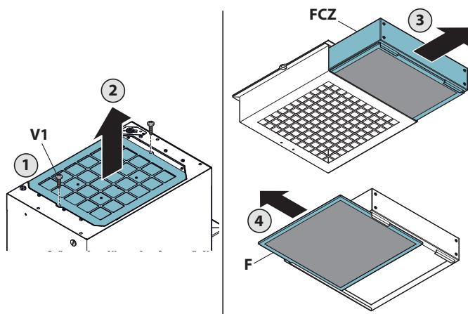
**Zeolit-kulfilteret og støvfilteret kan ikke vaskes.**
