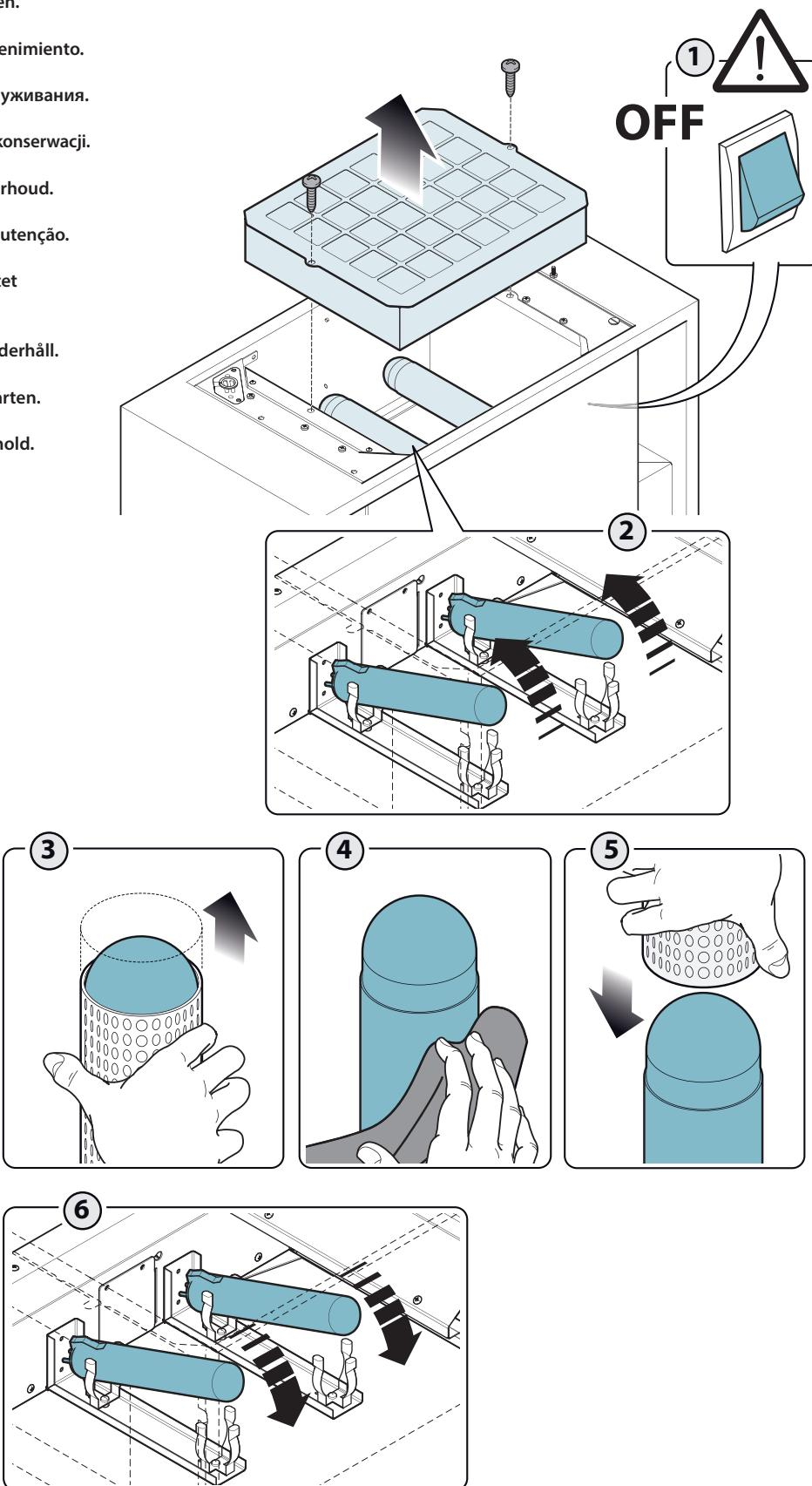
IT - Rimozione ionizzatori per manutenzione.
