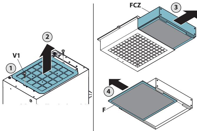
**Hiili-zeoliitistä valmistettua suodatinta ja alempaa suodatinta ei ole mahdollista pestä.**
