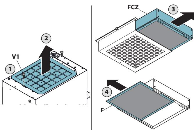
**Het zeoliet-koolstoffilter en het onderste stoffilter zijn niet uitwasbaar.**
