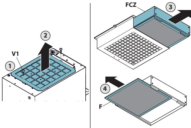
**Karbon/zeolitt-filteret og det nedre støvfilteret kan ikke vaskes.**
