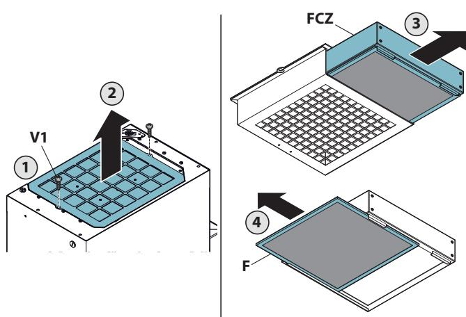
**El filtro carbón-zeolita y el filtro antipolvo inferior no pueden lavarse.**
