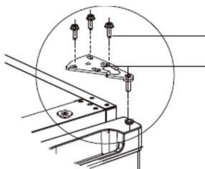
2. Démontez la porte et l'ensemble charnière inférieure et pied réglable, puis montez l'ensemble charnière inférieure et pied réglable de l'autre côté.
