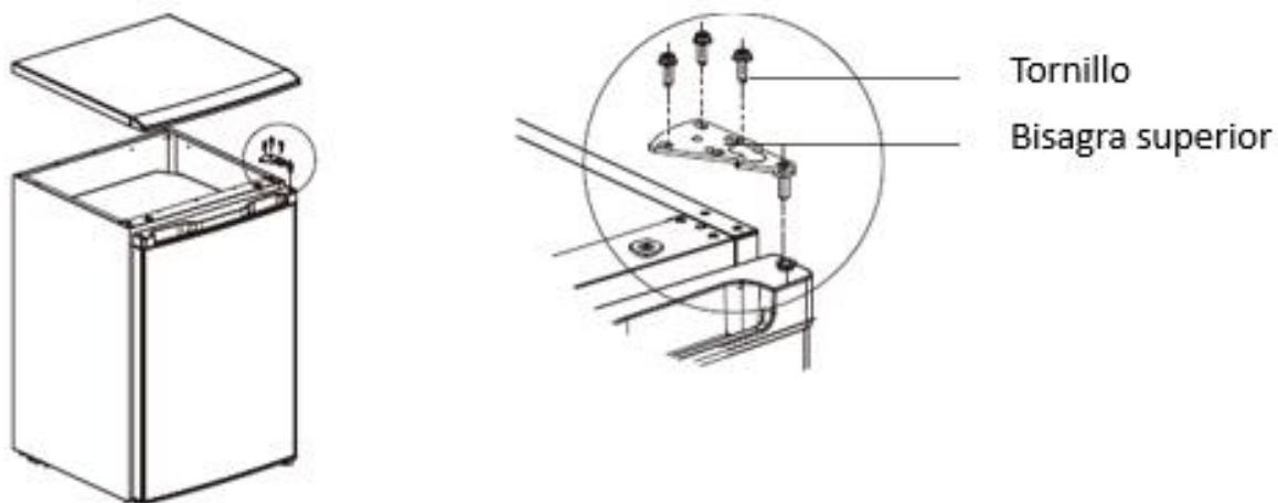
2. Desmonte la puerta y el conjunto de la bisagra inferior y el pie ajustable, luego monte el conjunto de la bisagra inferior y el pie ajustable en el otro lado.
