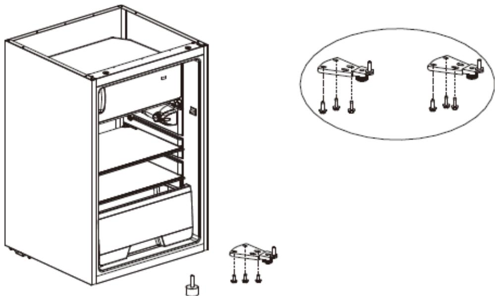
3. Coloque la puerta en la bisagra inferior y Monte la bisagra superior, los tornillos y la tapa superior.
