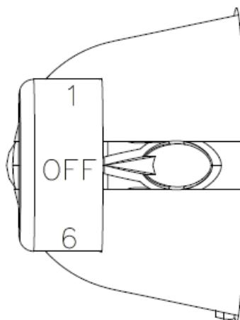
Su frigorífico está equipado con un termostato situado en el interior del aparato.
